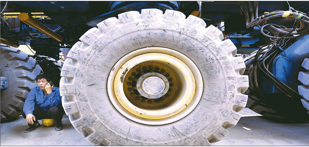
吊装桥梁的吊车安装了56个直径约2米的巨型车轮,中午停工时车轮后就成了工人们躲避烈日的好地方
